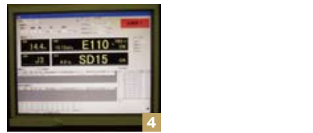
1.品質検査の工程では、職人が目視。割れ、虫食い、色、腐れをチェックし、AグレードとBグレード以下に仕分ける。かなりの材木がここでハネられる／2・3. マイクロ波で芯まで含水率を測定し、木口を叩いた振動周波数でヤング係数を測定する／4. スギはSD(含水率)20以下、E(ヤング)70以上、ヒノキはE90以上が合格で、それ以外は山長ブランドとして流通しない
