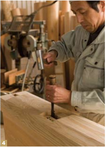
1.プレカット機械に木材を投入する時にも、平面図などを見ながら職人の目によって品質・配置の最終確認がなされる／2.木口にも番付が記入される／3. 工務店の希望に応じた銘柄を刷りこむことができる／4. 機械でプレカットできない部分は、熟練大工の腕の見せ所
